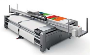
swissQprint präsentiert sein fünfteiliges Druckersortiment. Dazu gehören unter anderem Hochleistungsmodelle, die bei bis zu 370 m<sup>2</sup>/h Output top Qualität liefern. Zum erweiterten Angebot gehören zudem Weiter- und Neuentwicklungen wie die Doppelrollenoption für parallelen Druck von zwei Rol-
